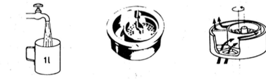
Figura 5 - Funcionamento de um contador volumétrico. Fonte: [18]
