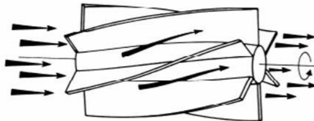
Figura 9 - Funcionamento de um contador Woltmann. Fonte: [25]
