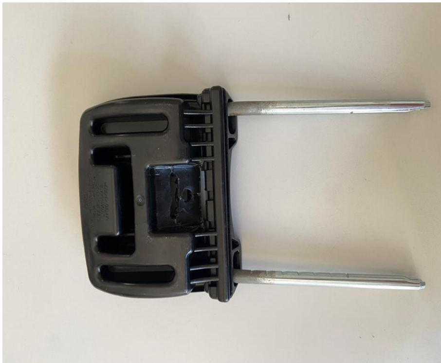
Figura 1- imagem do protótipo do encosto de cabeça de um Ford S max.
