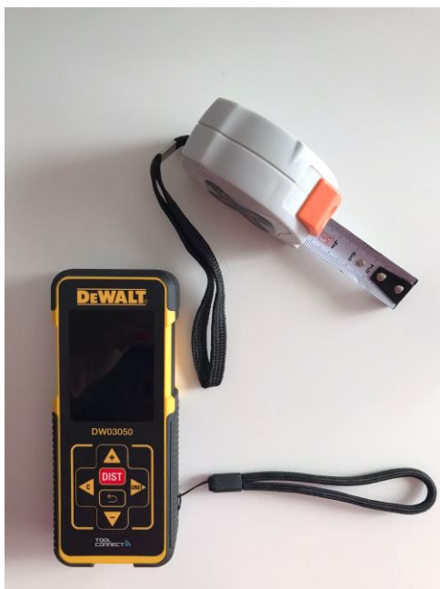
Figura 7 - Instrumentos Medição, Laser Medidor e Fita Métrica
