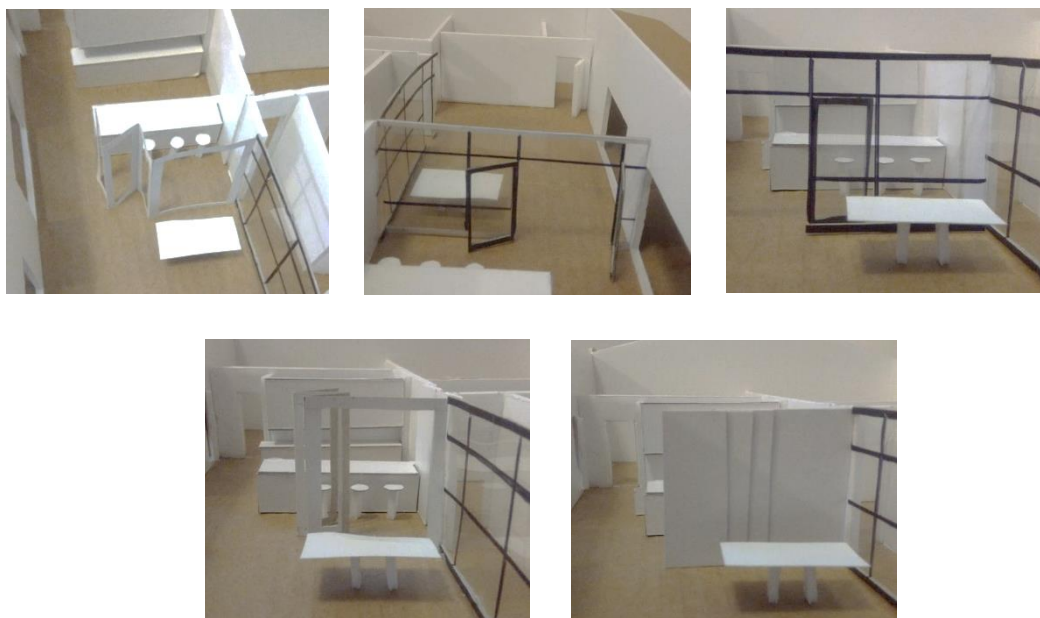
Figura 62 – Conjunto de imagens (esboços e maquete de estudo, na escala 1/50 em cartão micro-canelado e k-line), para estudar soluções possíveis, acerca da divisória que era necessária para criar separação no decorrer dos workshops de culinária.
