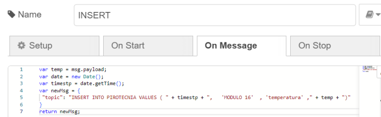
Figura 32 - Código JavaScript para a introdução de valores na Base de Dados
