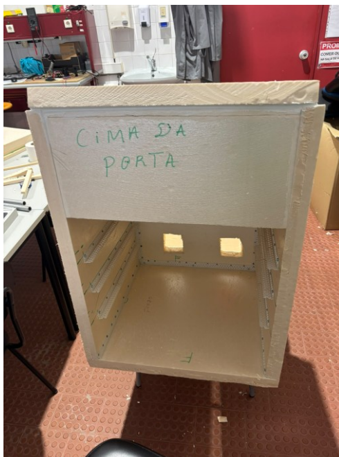
Figura 31: Montagem da estrutura de suporte das bandejas
