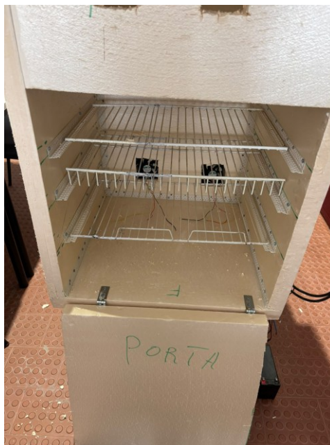
Figura 34: Vista interior da câmara de secagem com as bandejas metálicas amovíveis. A Figura 35 apresenta o protótipo montado, destacando os seguintes componentes principais:
