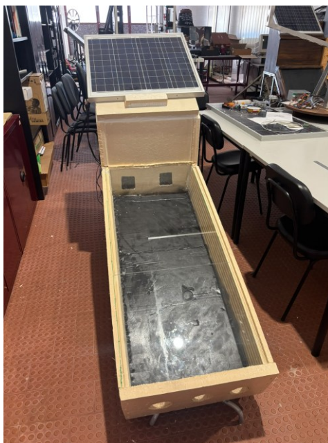
Figura 36: Vista superior do coletor solar, evidenciando o vidro de cobertura, o fundo negro absorvedor e o suporte estrutural em ferro.
