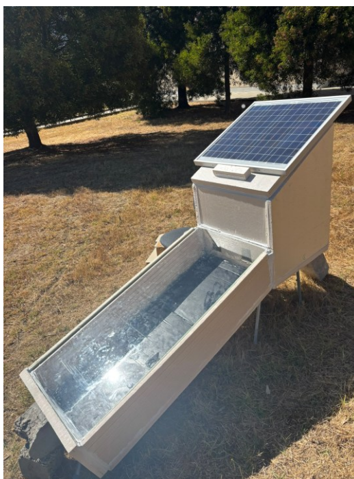
Figura 57: Montagem do protótipo de desidratador solar em ambiente externo para ensaio experimental.
