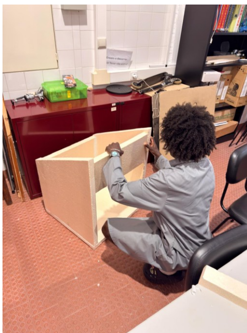
Figura 30: Fase inicial da montagem, focada na base do desidratador.
