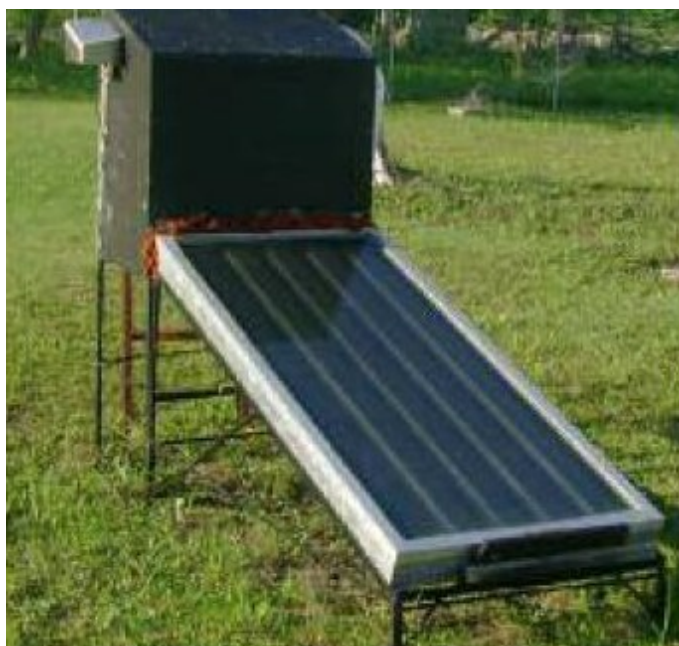
Figura 24: Exemplo de um desidratador solar indireto. (figura adaptada de [25])
