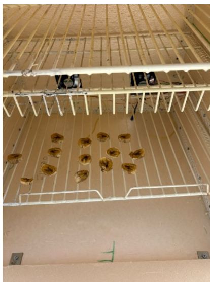
Figura 58: Vista interior do protótipo do desidratador solar, com as amostras de banana dispostas na grelha de secagem durante o ensaio.
