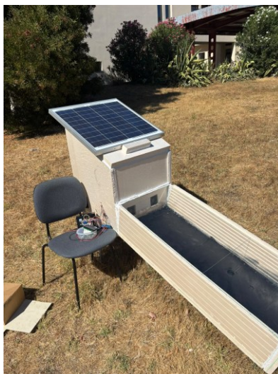
Figura 59: Vista geral do protótipo de desidratador solar durante o ensaio experimental, com destaque para a unidade de monitorização e as ligações aos sensores.
