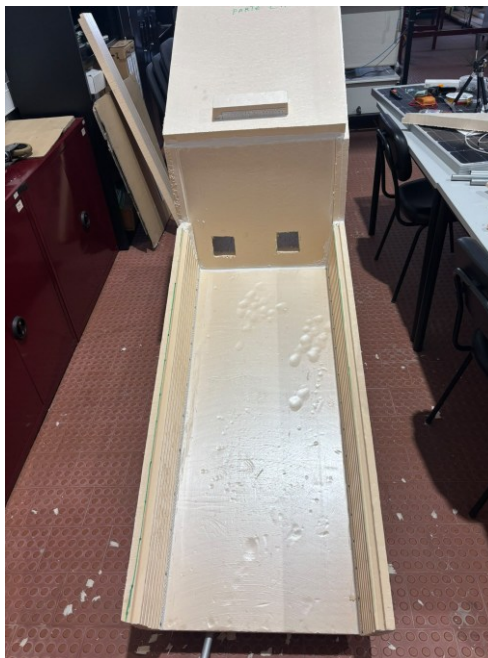
Figura 33: União do coletor solar com a base.
