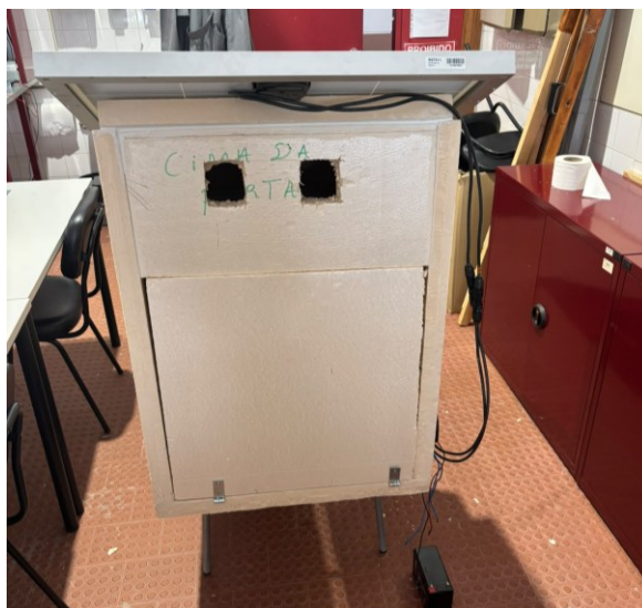
Figura 35: Vista global do protótipo integrado, evidenciando o painel solar, o suporte em ferro e a bateria de armazenamento.
