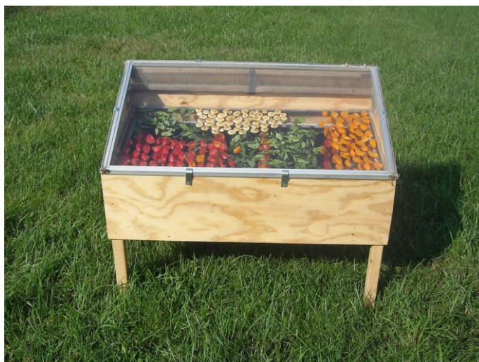
Figura 23: Exemplo de um desidratador solar direto. (figura adaptada de [28])
