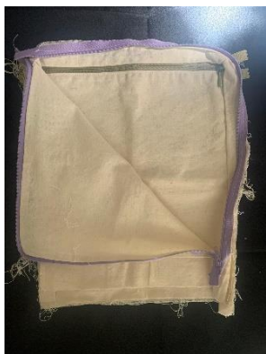
Figura 3 Fundo falso localizado nas costas da mochila, com espaço de 4 cm largura. Amostra realizada em pano cru.
