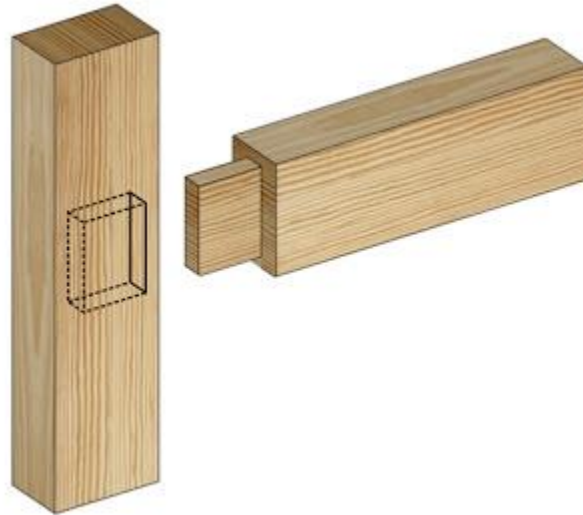
Imagem 36 – Encaixe de Respiga ou Respiga Cega; http://aluiziotomazelli.blogspot.com/2011/02/espigas-seus-tipos-e-seu-uso-22.html consultado a 24 de maio de 2021
