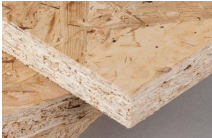
Imagem 31 – Exemplo de OSB; Artimol, https://www.artimol.pt/placas-de-derivados-de-madeira-e-outros/2816-2258034.html ; consultado a 16/05/2021
