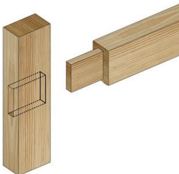
Imagem 38 – Encaixe de respiga e fura vazada; http://aluiziotomazelli.blogspot.com/2011/02/espigas-seus-tipos-e-seu-uso-22html consultado a 24 de maio de 2021
