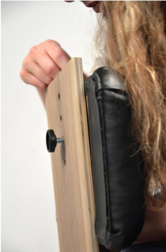
Imagem 132 e 133–Pormenores da solução encontrada para alterar a altura da cadeira
