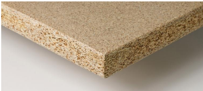
Imagem 32 – Exemplo de Aglomerado; Banema, https://www.banema.pt/pt/produtos/paineis-de-madeira/aglomerado/aglomerado-standard/ ; consultado a 16/05/2021
