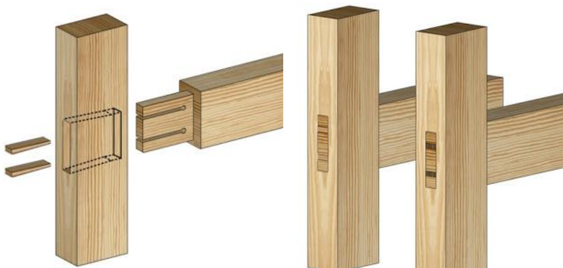
Imagem 39 e 40 – Encaixe de Respiga e fura vazada; http://aluiziotomazelli.blogspot.com/2011/02/espigas-seus-tipos-e-seu-uso-22html consultado a 24 de maio de 2021
