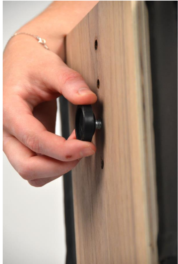
Imagem 132 e 133–Pormenores da solução encontrada para alterar a altura da cadeira
