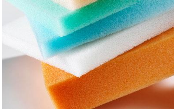
Imagem 57 – Espuma de poliuretano; Ossur Plásticos, http://www.ossurplasticos.com.ar/Poliuretano consultado a 18 de maio de 2021
