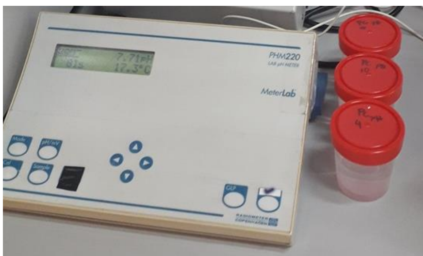
Figura 3 - Equipamento de medição de pH por método eletrométrico
