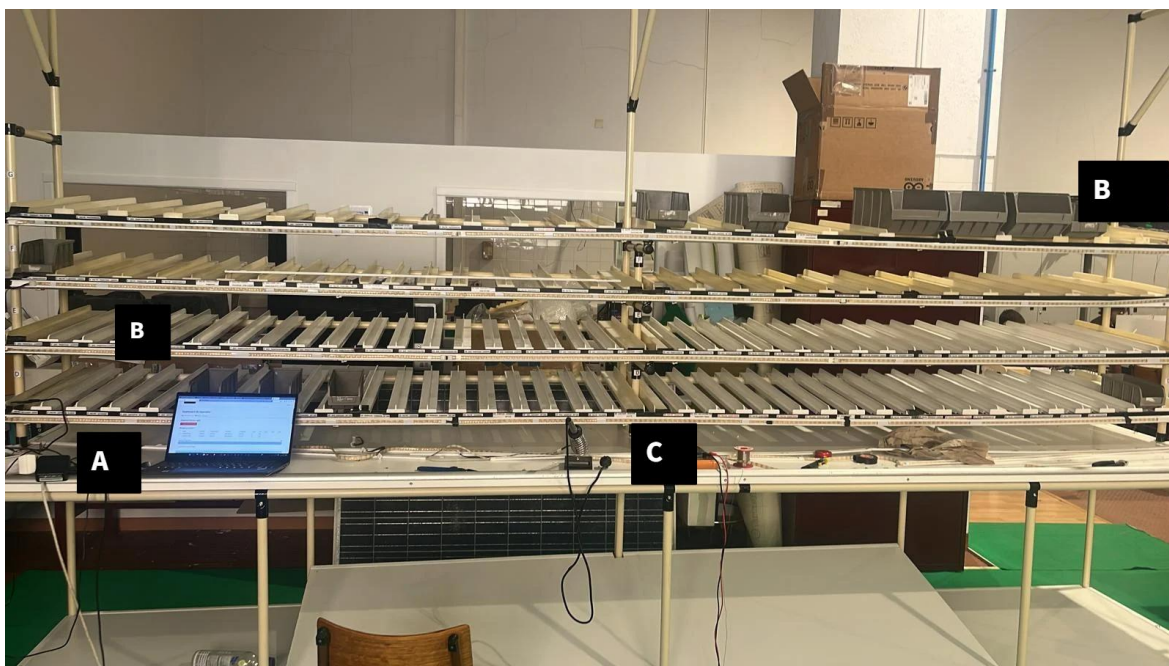
Figura 1 - Posto de trabalho de retração de componentes com indicação das zonas principais (A – posição do operador, onde também realiza a leitura do código de barras; B – bancada de caixas de componentes; C – zona de retração).
