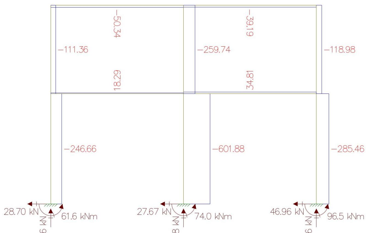
Figura 7 - Diagrama de Esforços Transversos envolvente (Modelo Rígido)
