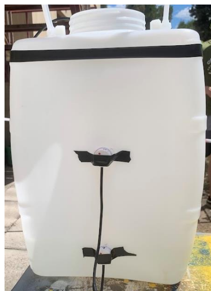
Figura 39 - Implementação Sensores de deteção de líquido
