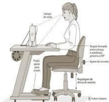
Figura 45- Ergonomia para máquina de Costura. Fonte: UFERSA, 2022
