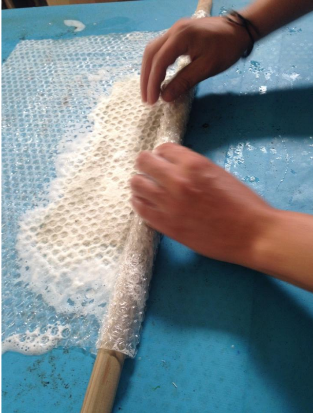
Ilustração 8 - Fotografia da minha autoria 4º passo: Momento em que o tecido é enrolado num pau, ou outro suporte qualquer para se iniciar a feltragem.
