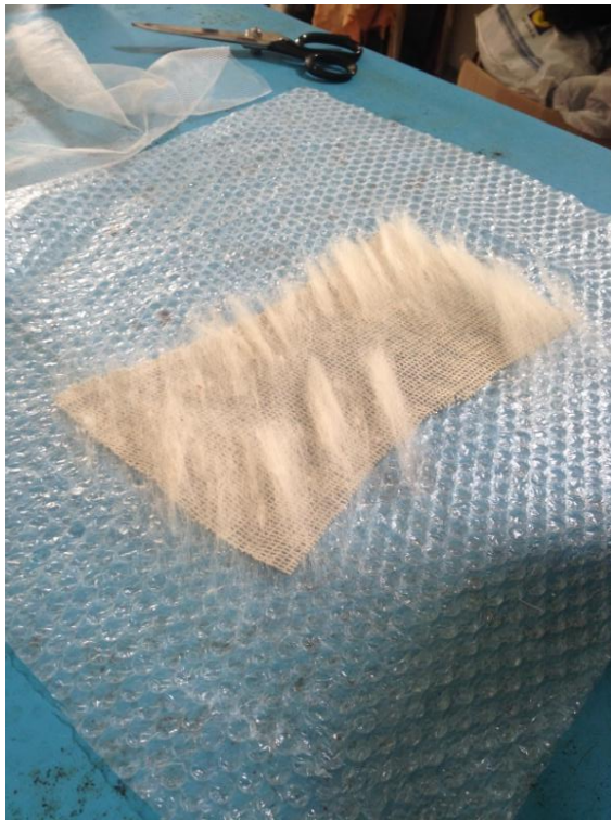
Ilustração 5 - Fotografia da minha autoria. 1º passo: Momento em que é colocada a lã em cima do tecido a 45° da teia e da trama, feito o cruzamento da teia e trama da lã com o tecido, isto é, a montagem da peça propriamente dita.
