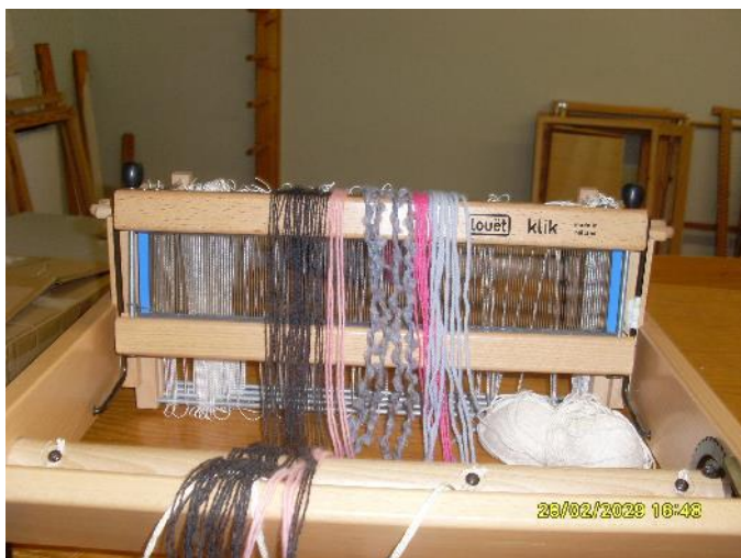
Figura 16 – Montagem da Teia no Tear Reduzido
