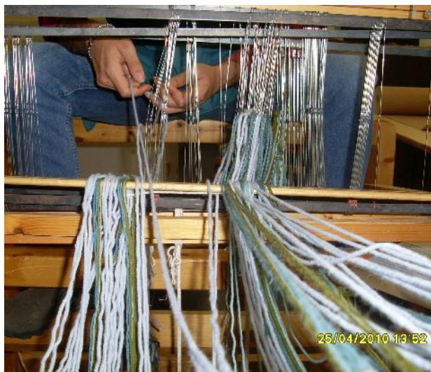
Figura 34 – Montagem da Teia nos Quadros
