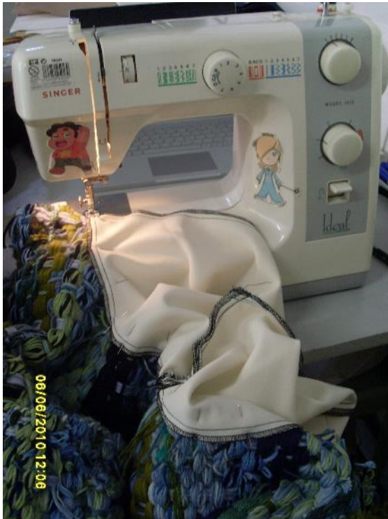
Figura 40 – União das componentes numa máquina de costura doméstica
