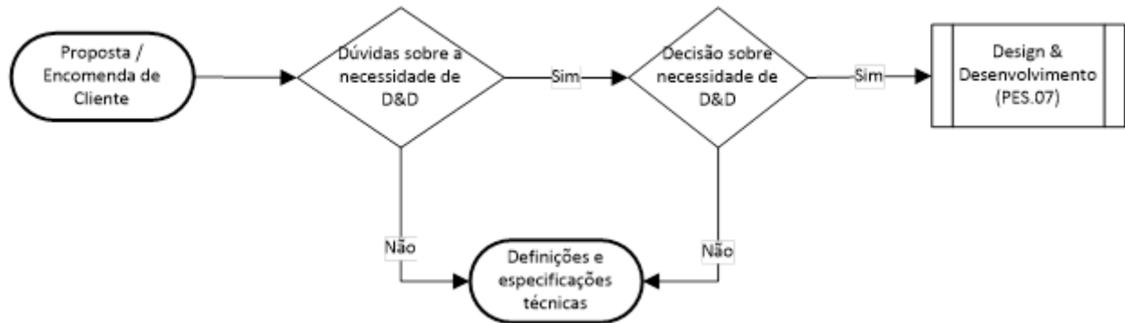
Figura 5 - Fluxograma Análise dos requisitos do cliente (Manual MECALBI, Mod.0001.PT-A, 2020)
