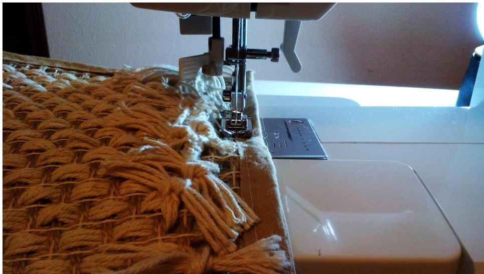
Figura 18 – Colocação de vivos em toda a volta das três partes constituintes da mochila (frente, costas e fundo) através de costura.
