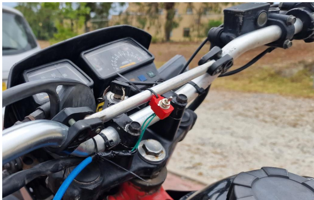
Figura 38 - instalação do botão ON OFF.
