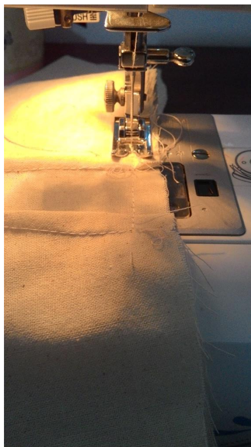
Figura 48 - Unir as duas partes da manga, com as pinças centradas
