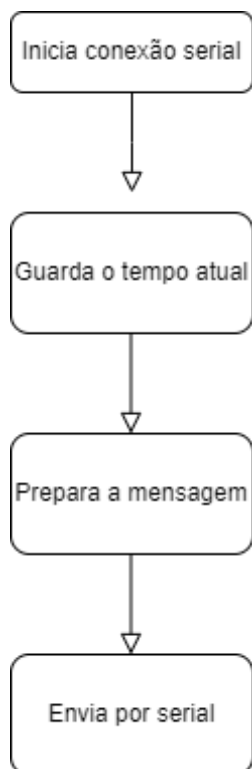
Figura 24 - Fluxograma da preparação da mensagem e envio para o nó ponte
