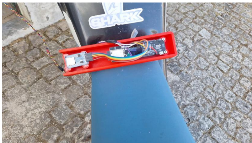
Figura 21- Montagem do sistema na moto
