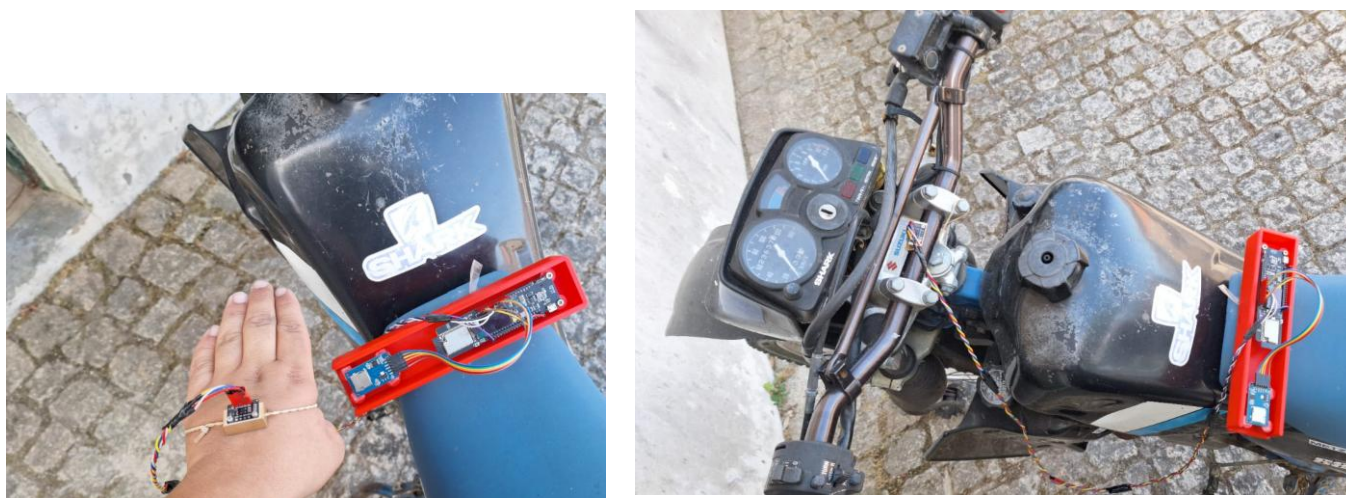
Figura 22- Colocação do acelerómetro no sistema mão braço e no guiador
