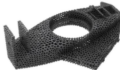
Figura 13 - Componente de corrida impresso em 3D EBM
