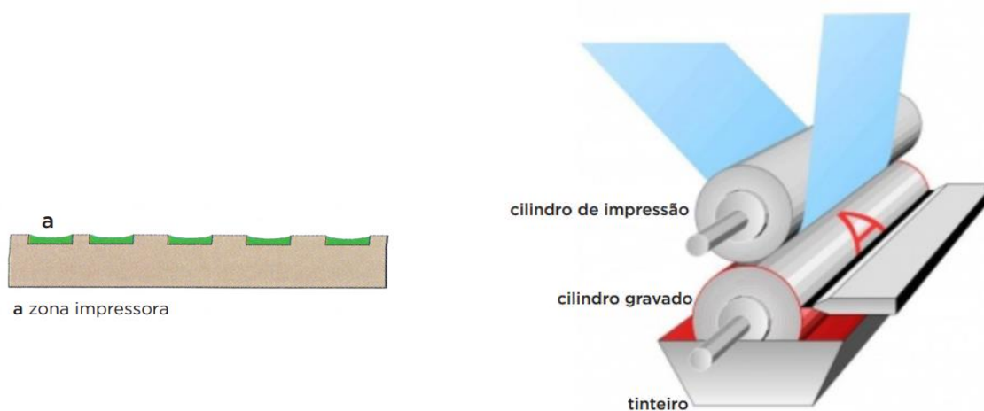
Figura 40. Processo de impressão no que toca à Rotogravura.
