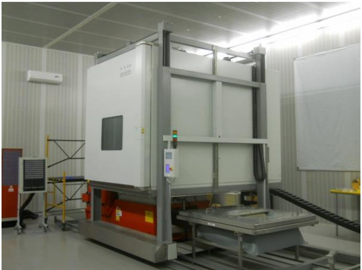
Figura 3.2 – Câmara climática acoplada ao Shaker, Fonte: ISQ
