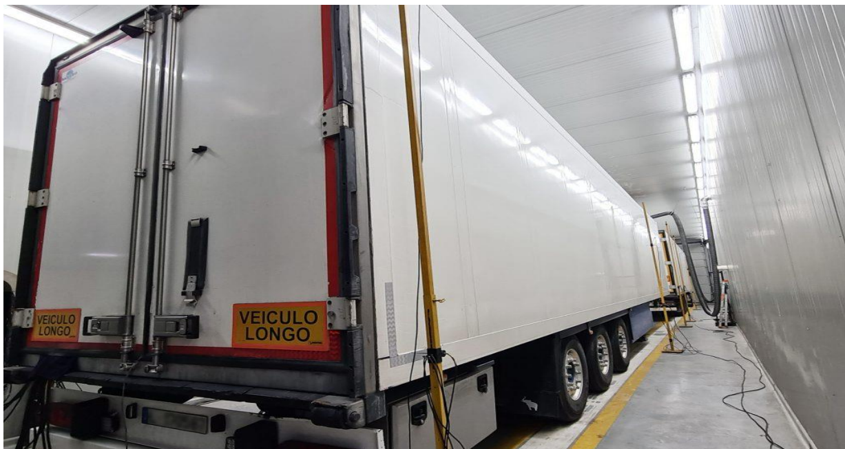
Figura 3.6 – Ensaio em Túnel Termodinâmico, Fonte: ISQ
