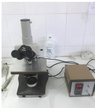
Figura 35- Microscópio ótico com fonte externa de aquecimento.
