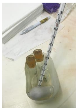
Figura 36- Copo com água a 33°C com ampola de ácido acético, termómetro e sémen diluído.
