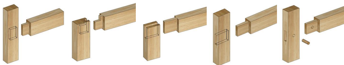
Figura 75. Encaixes de espiga.
