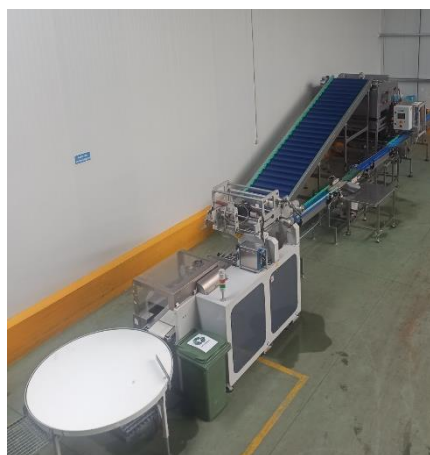
Figura 10- Máquina de embalamento das cerejas em cuvetes de 0,5 kg
