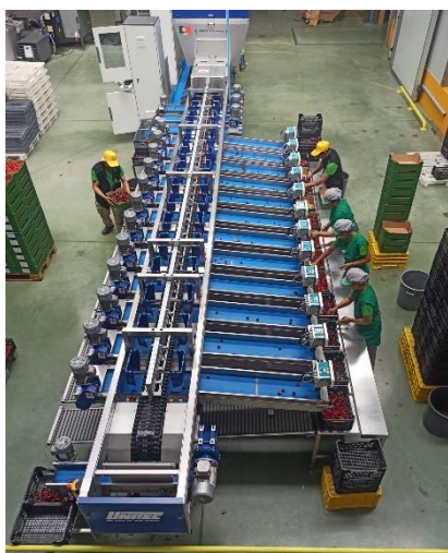
Figura 9- Calibrador automático de cerejas
