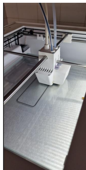
Figura 2 Impressora Ultimaker S5 (esquerda). Impressora imprimindo o provete (direita).
