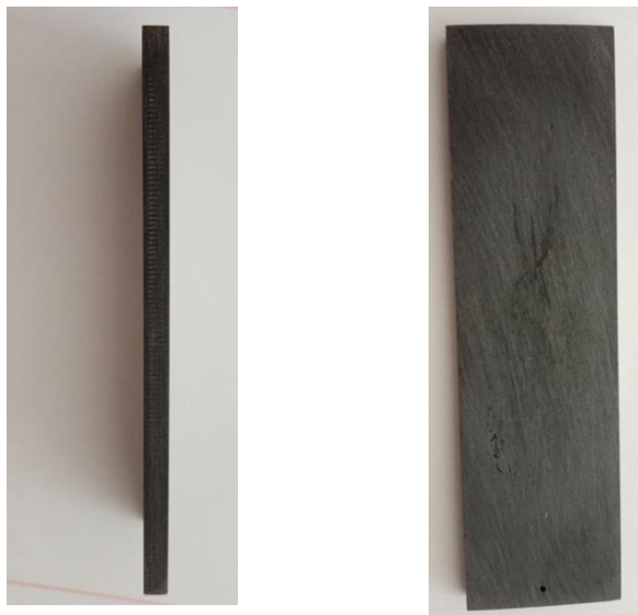
Figura 7: orientação de impressão Axial à esquerda e transversal à direita.
