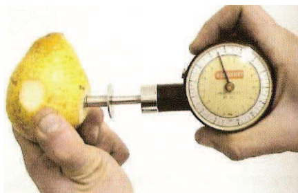
Figura 7 - Determinação da dureza de uma pêra com um penetrómetro de bolso (Soares et al., 2001)
