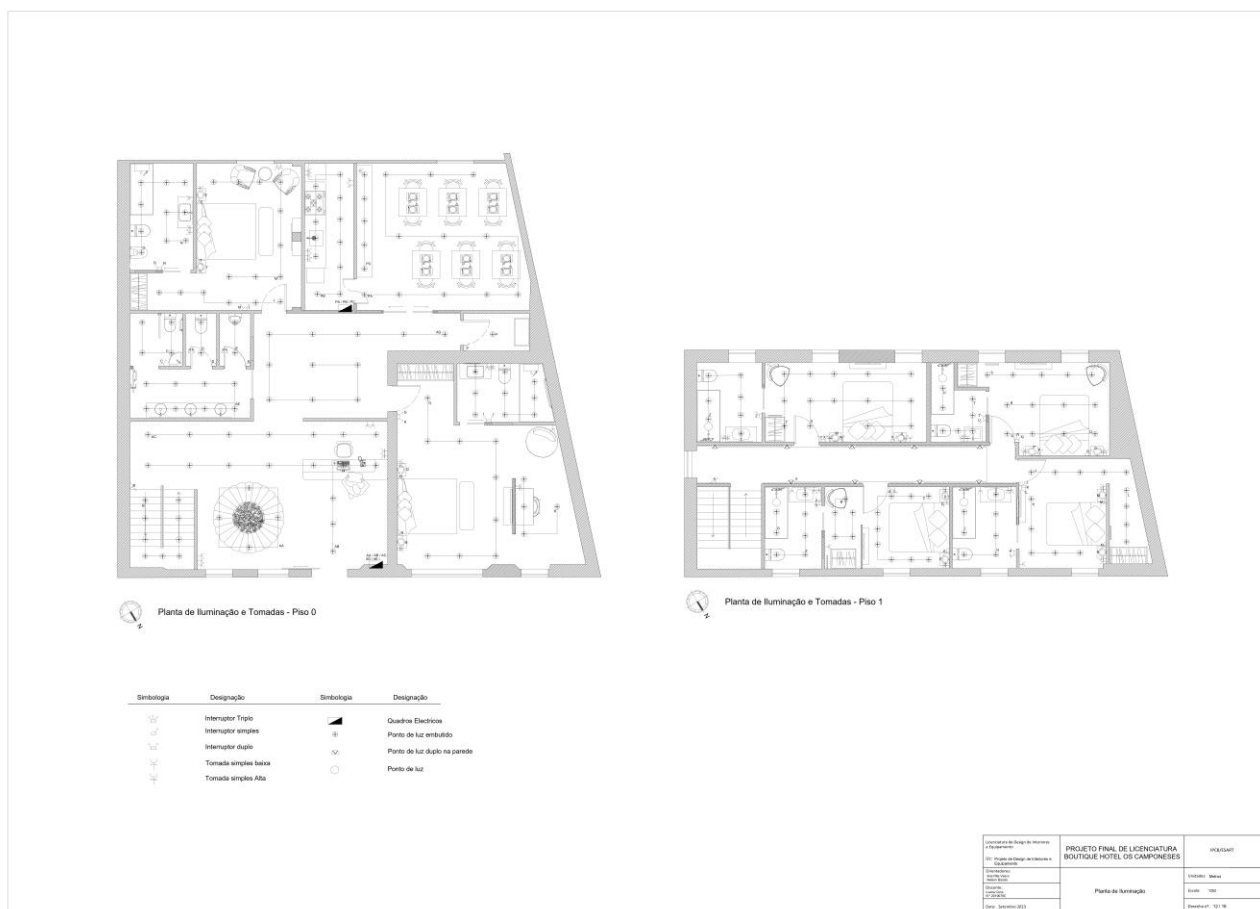
Figura 56 - Planta de Iluminação
