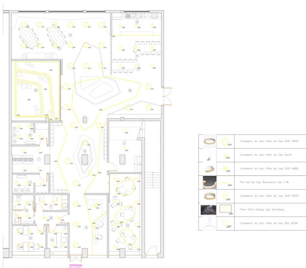
Figura 56- Planta de iluminação. Fonte: Augusta Ngonga,2024.
