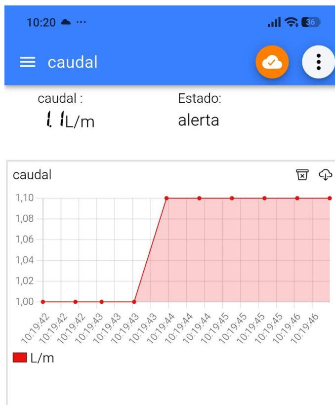
Figura 41 - Demonstração da monitorização do caudal e alteração do estado do sistema
