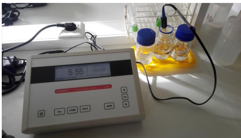
Figura 4 Medidor de ph com as soluções de NaOH e HCl
