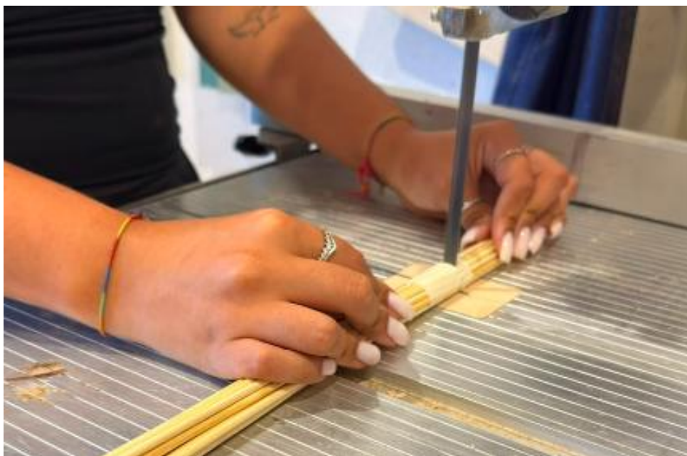
Figura 163- Corte dos Varões na Serra de Fita
