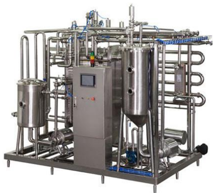
Figura 4- Equipamento de pasteurização para laticínios (Alpine Dairy Solutions, 2024).
