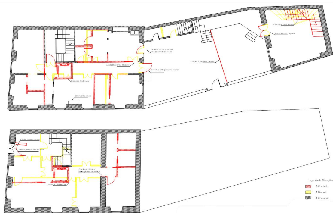
Figura 54 - Planta de alterações - Piso 0 e Piso 1
