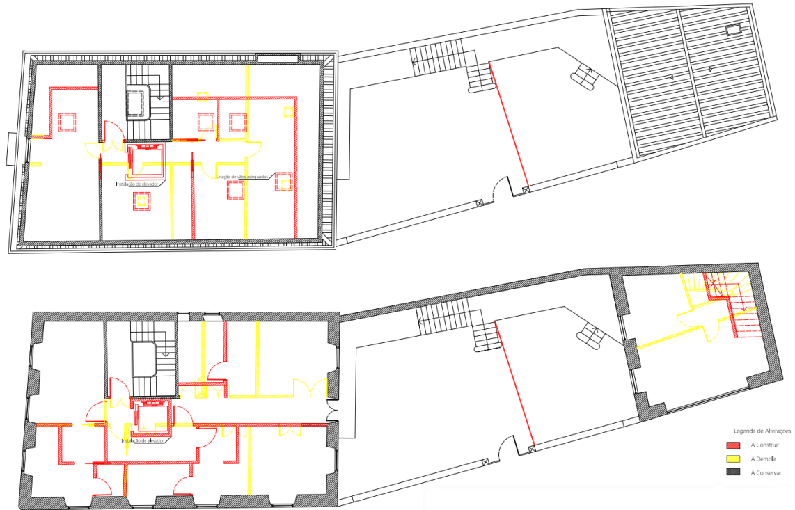
Figura 55 - Planta de alterações - Piso 2 e Piso 3
