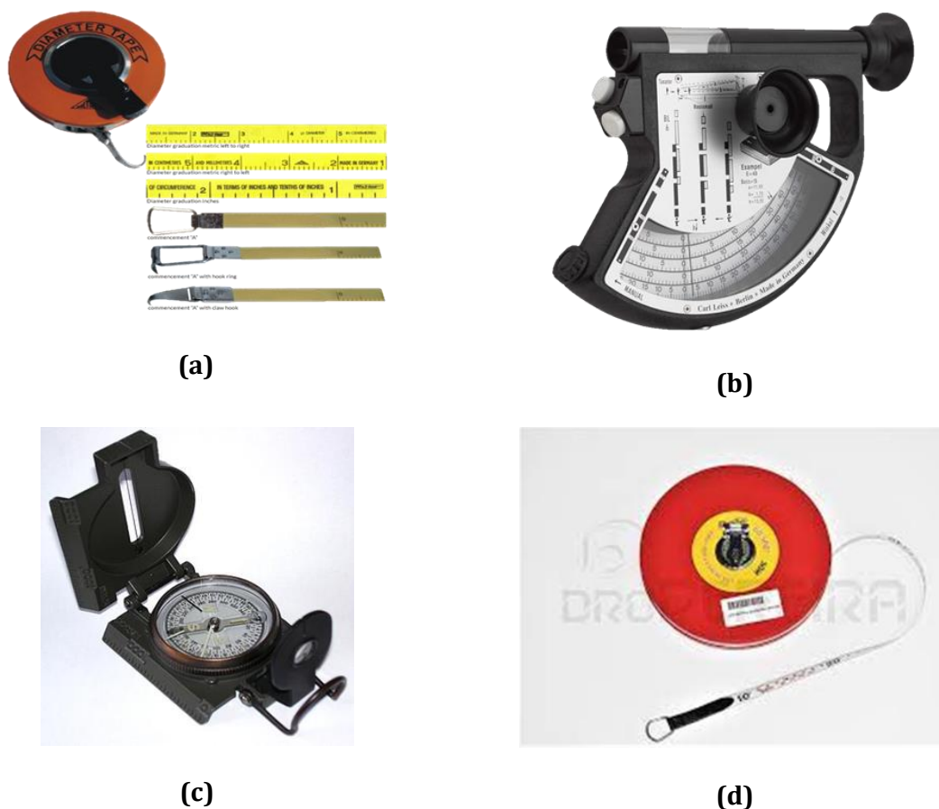
Figura 5. Instrumentos de medições em campo: (a) Fita de diâmetro, (b) Hipsómetro de Blume Leiss, (c) Bússola, (d) Fita de 50 metros.
