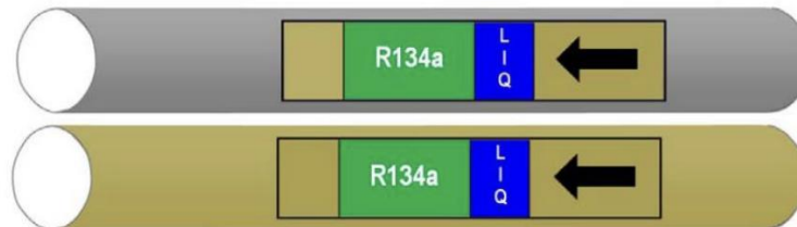
Figura 19: Identificação de tubagens. (Figura copiada [18])
