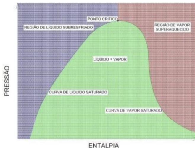
Figura 6: Diagrama de pressão e entalpia (P-h) (Figura copiada [4])
