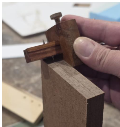
Figura 69- Marcação feita com um graminho, 2026
