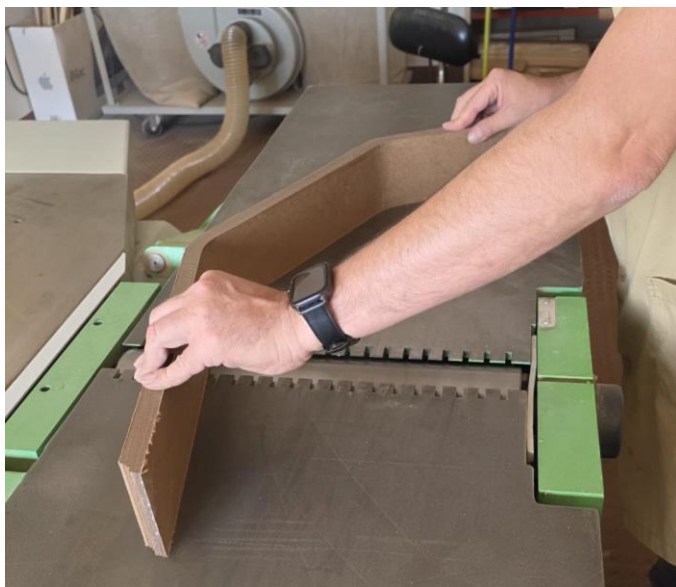
Figura 58- Aparelhamento das travessas, 2026
