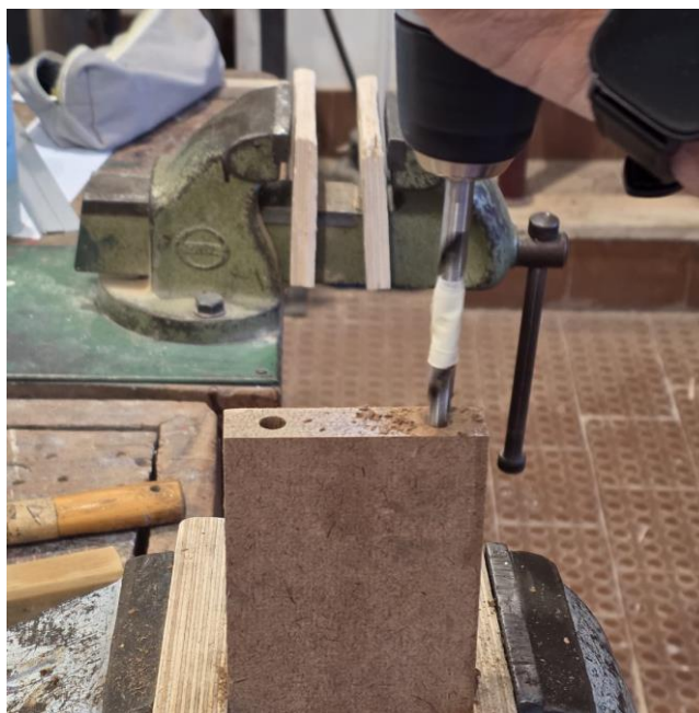
Figura 71- Furação das travessas com berbequim, 2026
