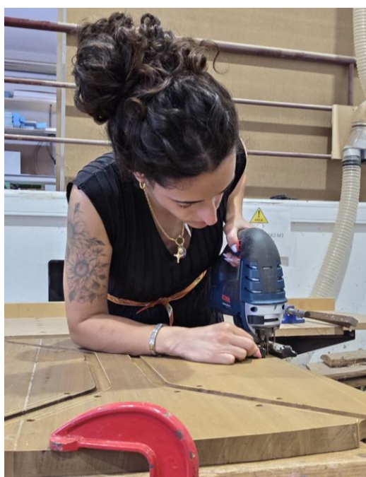
Figura 61- Corte do tampo com serra tico-tico, 2026
