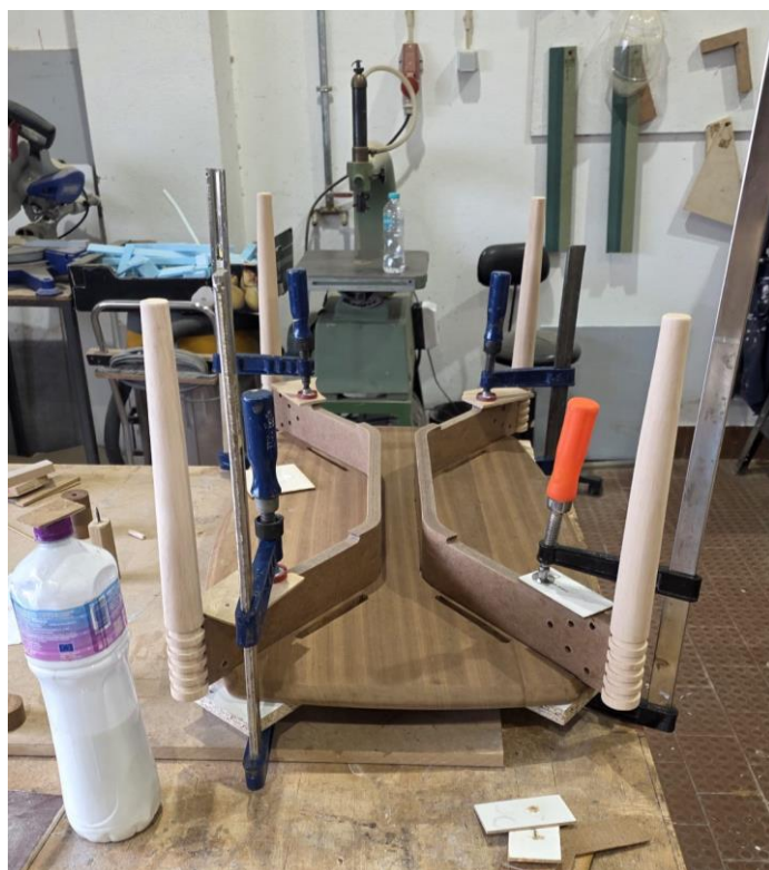
Figura 73- Colagem da banqueta, 2026
