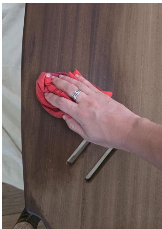
Figura 76- Aplicação da cera na banqueta com boneca de trapo, 2026
