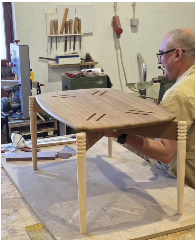
Figura 72- Montagem da banqueta a seco, 2026
