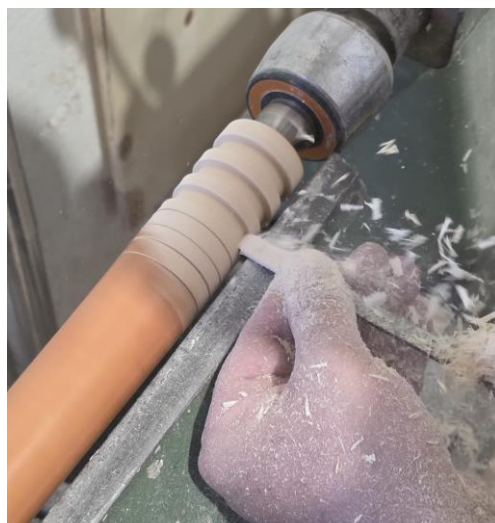
Figura 67- Rebaixos nos pés feitos num torno com um formão de 8mm, 2026
