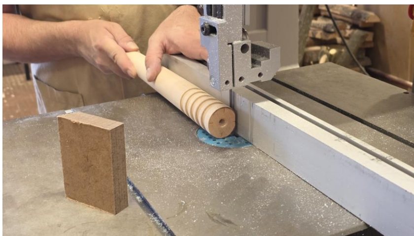
Figura 68 - Corte na zona superior do pé na serra de fita, 2026
