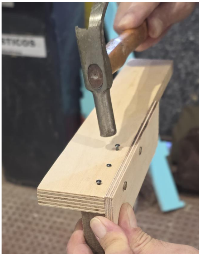
Figura 70- Marcação das furações nas travessas com gabarito, 2026
