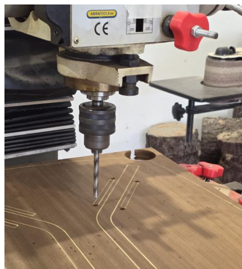
Figura 63- Furação do tampo com broca de 8mm, 2026
