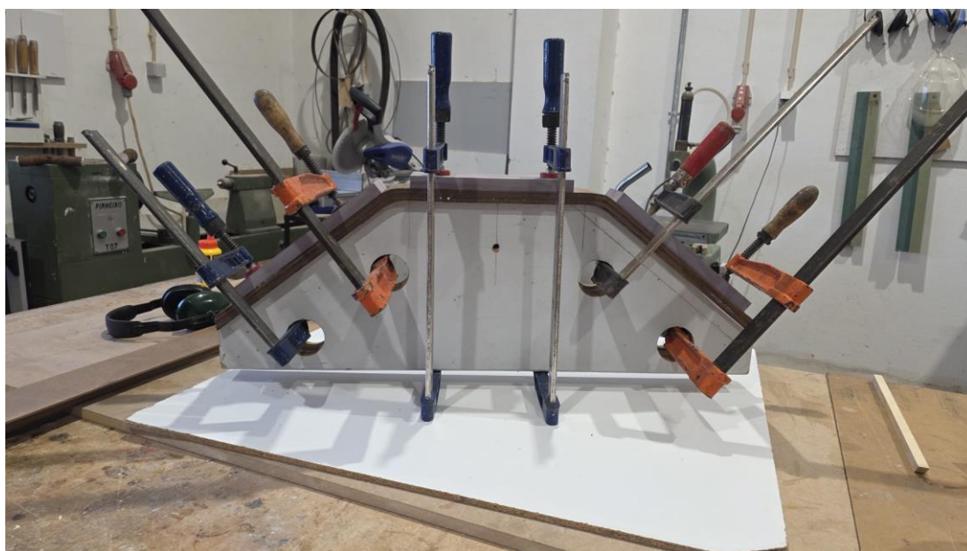
Figura 57- Moldagem das travessas no molde (Autor: Carolina Matos, 2026)
