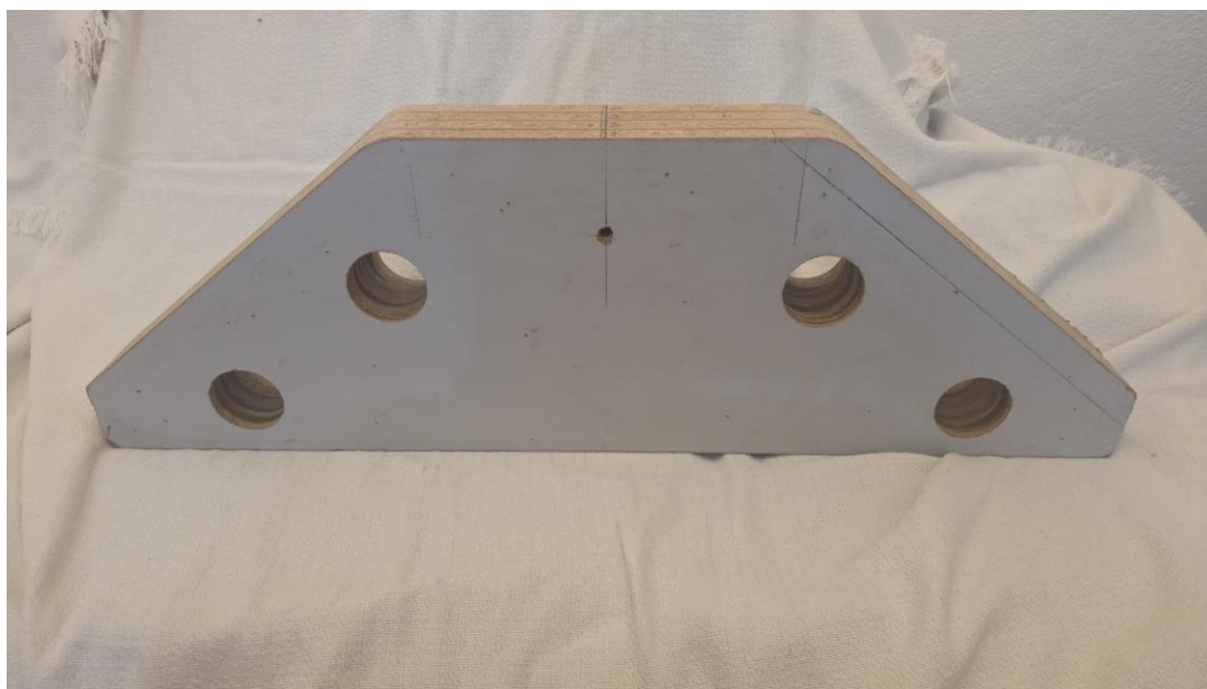
Figura 56- Molde em aglomerado de madeira, 2025
