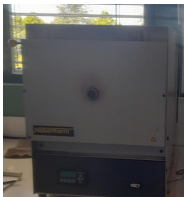
Figura 17: Mufla utilizada para determinação das cinzas das amostras de macroalgas (mufla Nabertherm L15 C6) no LNAA.
