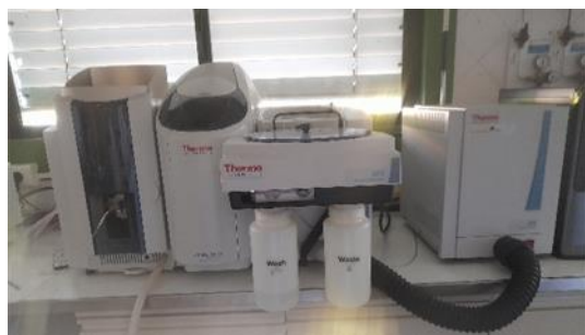
Figura 22: Ice 3000 Series Atomic Absorption Spectrometer utilizado para determinação dos minerais no laboratório de solos (LS).
