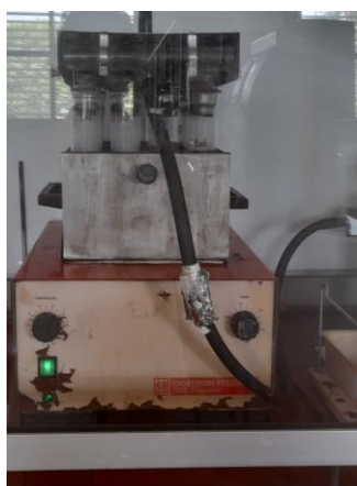
Figura 20: Sistema de digestão (Tecator Digestion System 6 - 1007 Digester) do LNAA.
