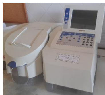
Figura 23: Evolution 300 UV-VIS Spectrometer utilizado para determinação do fósforo no LS.
