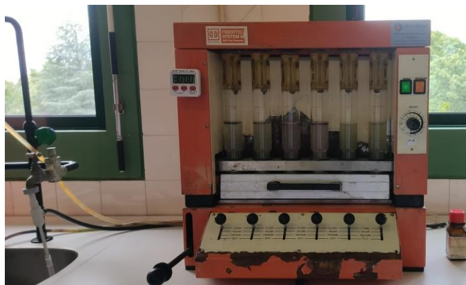
Figura 19: Unidade de extração Fibertec para determinação da fibra bruta de Weende das amostras de macroalgas (Tecator Fibertec System M6, 1020 Hot Extractor).
