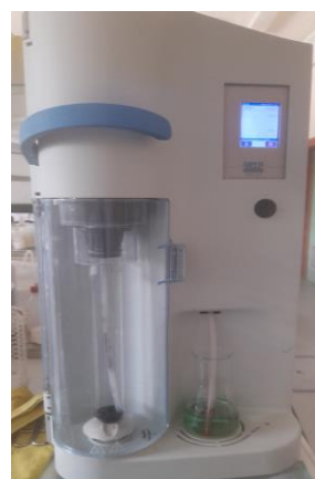
Figura 21: Equipamento de destilação (Velp UKD 139 - Semi-Automatic Kjeldahl Distillation unit) do Laboratório de Solos- LS.
