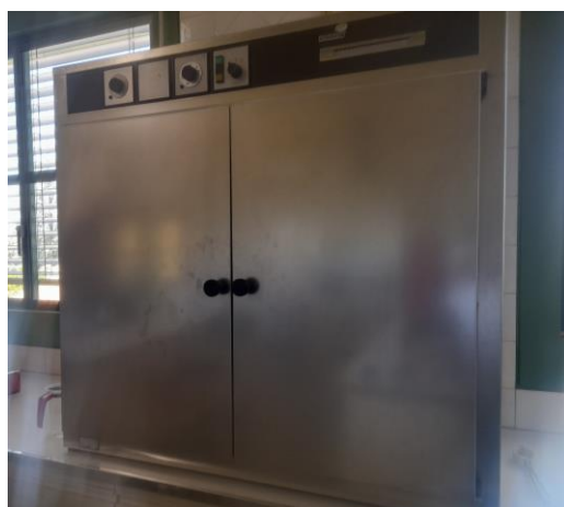
Figura 16: Estufa utilizada para determinação da humidade das amostras de macroalgas (Estufa Memmert UL 60) do Laboratório de Nutrição para Alimentação Animal (LNAA).
