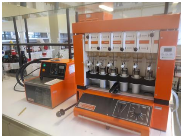
Figura 18: Sistema Soxtec para a determinação da gordura bruta das amostras de macroalgas (Tecator Soxtec System HT, e a unidade de extração 1043 Extraction Unit associado a uma unidade de aquecimento 1046 Service Unit) com cartuchos de celulose de papel, copos de alumínio e suportes metálicos.
