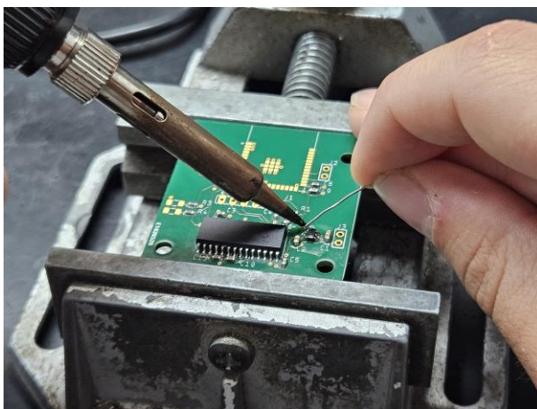
Figura 24- Soldadura dos componentes
