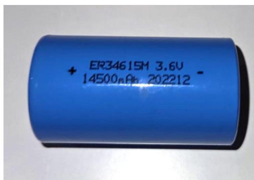
Figura 26- Bateria de Alimentação do circuito
