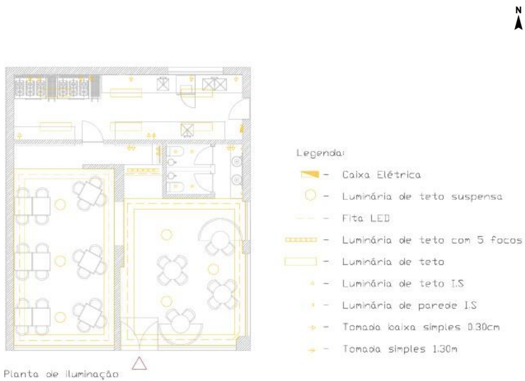
Figura 58 – Planta de iluminação
