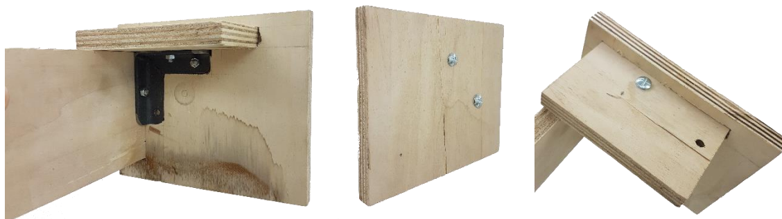
Figura 26 – Maqueta de teste dos elementos metálicos de junção
