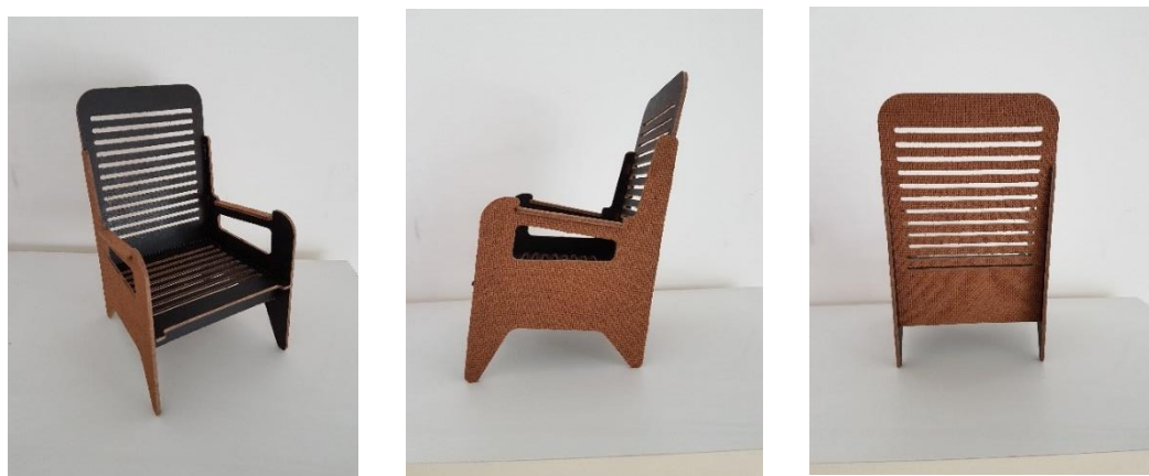
Figura 27 – Maqueta à escala 1:5 cortada em CNC
