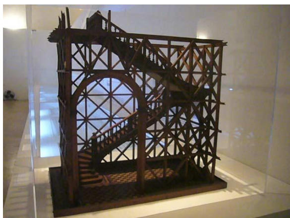
Figura 7 Maquete de exemplo de estrutura em gaiola Fonte: http://www-ext.lnec.pt/LNEC/DE/NESDE/divulgacao/gaiol_const_sism.html
