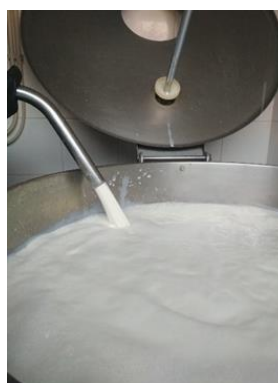
Figura 7- Tanque de refrigeração
