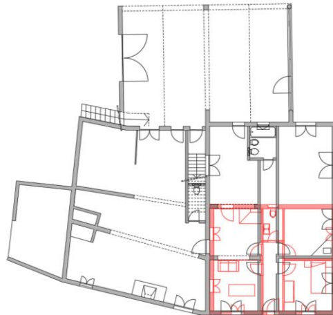
Figura 11- Sobreposição da planta existente com a licenciada, fonte: Documentos Oficiais e autora Maria Santos
