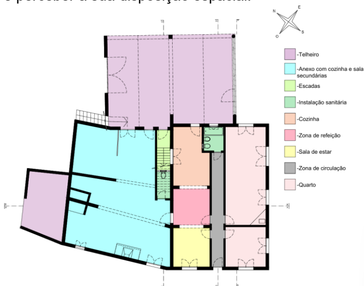
Figura 4- Planta existente do piso 0, autora: Maria Santos
