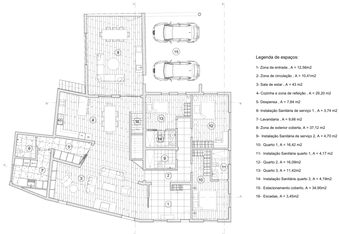
Figura 114 - Planta de zonamento, piso 0
