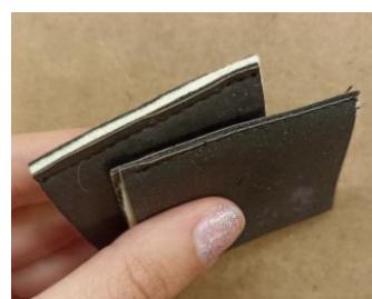
Figura 53 - Estudo da ligação da cortiça ao feltro (Fonte: Autor)
