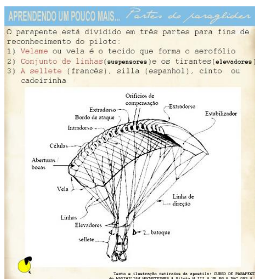
Figura 1 As partes de um parapente
