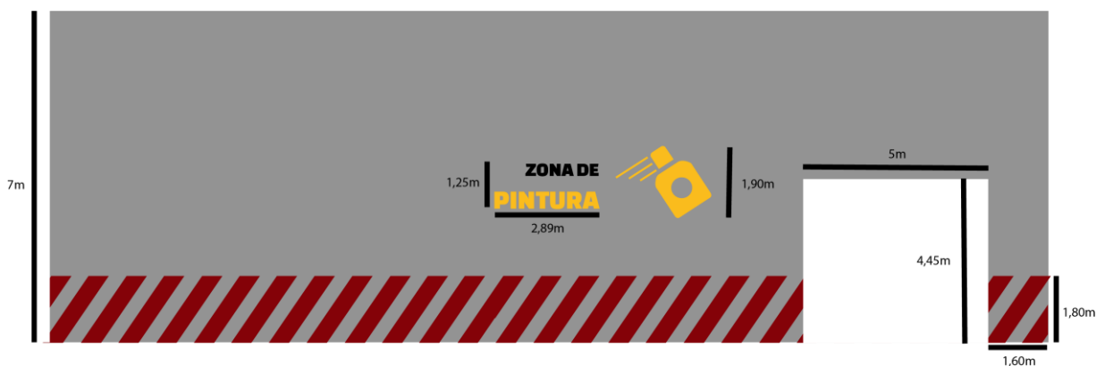
Figura 120- Zona de Pintura Sinalética. Fonte: Autora
