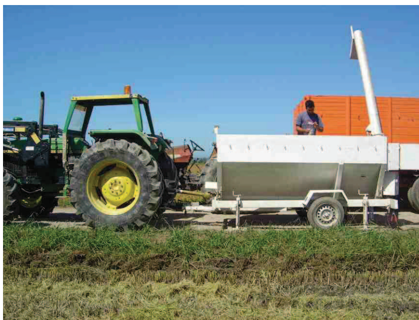
Figura 11: Retirar amostra do tegão- pesa.
